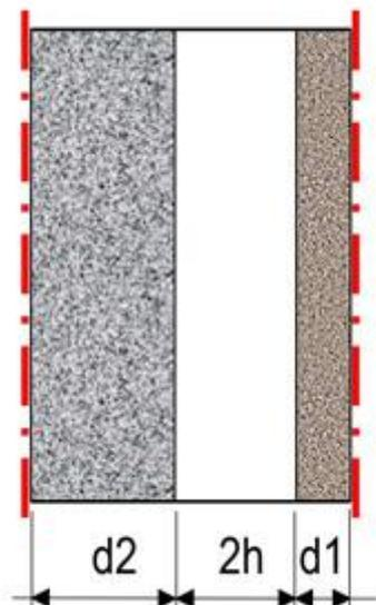
Figure 11 Coupe transversale d'un sous-ensemble d'un silencieux à baffles avec garnissages absorbant les sons alternés i.e. dissemblables (asymétriques) ; les plans de symétrie sont figurés en rouge
