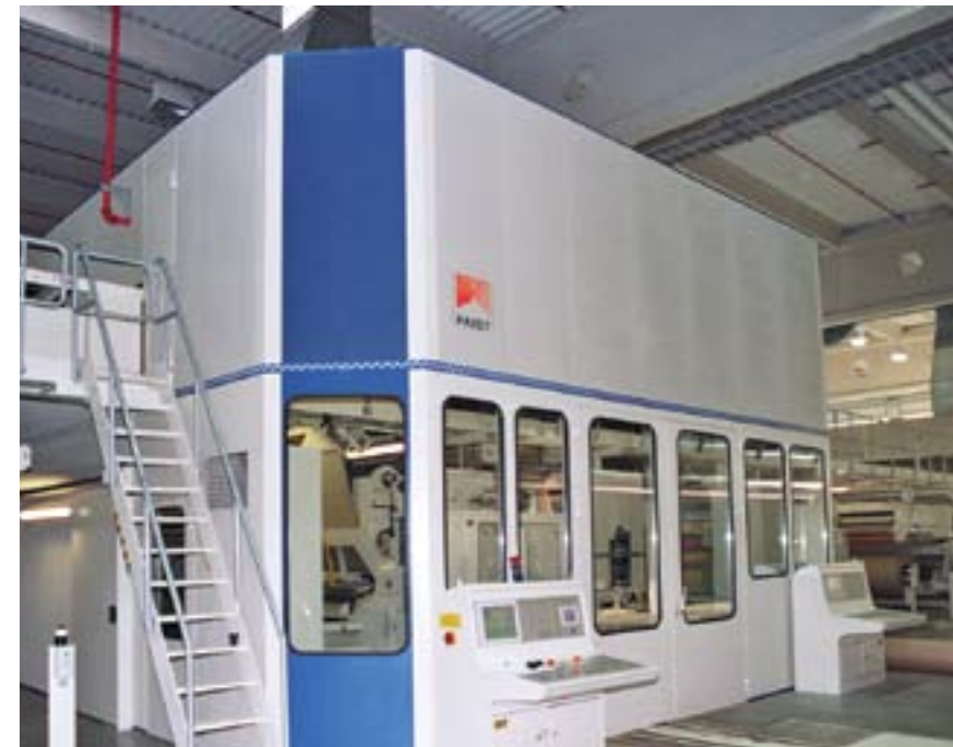
Insonorisation d'une onduleuse BHS, Eurowell, Wörth, Allemagne
