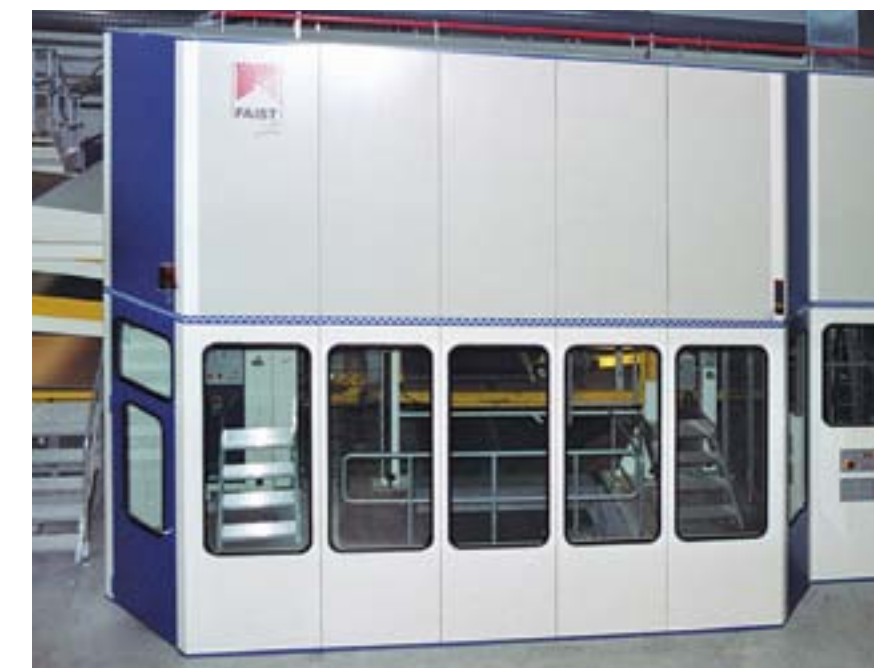
Photo ci-dessus : insonorisation de la dry end. Eurowell, Wörth, Allemagne Photo à droite : cloison acoustique pour la dry end. Kolb, Memmingen, Allemagne
