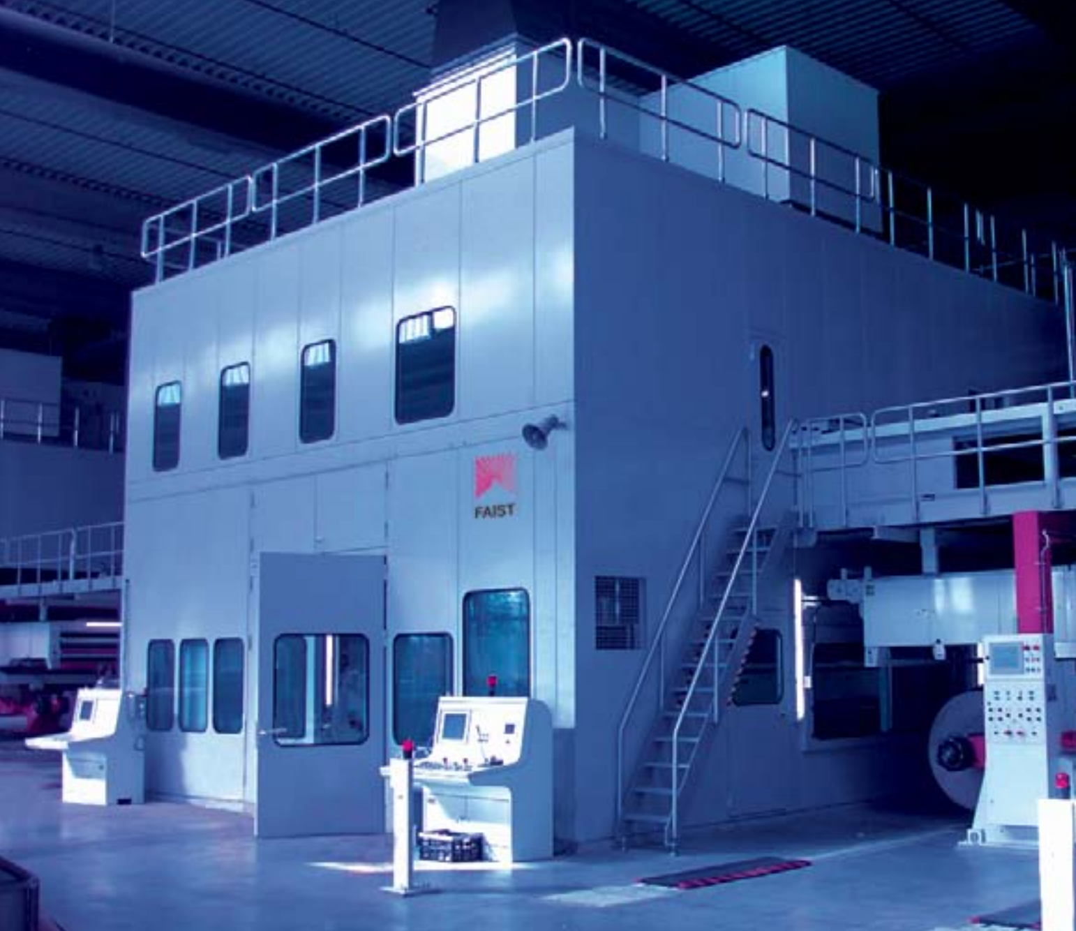
Insonorisation d'une onduleuse BHS, Eurowell, Wörth, Allemagne
