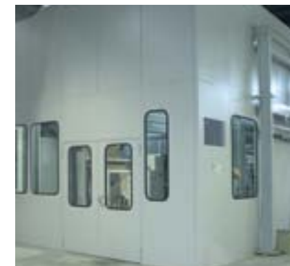
Encoffrement d'une onduleuse Asitrade
