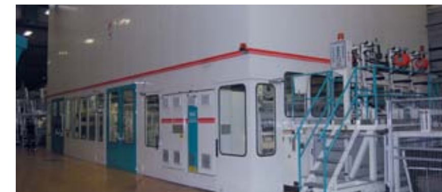
Photo ci-dessus : insonorisation de la dry end. Eurowell, Wörth, Allemagne Photo à droite : cloison acoustique pour la dry end. Kolb, Memmingen, Allemagne
